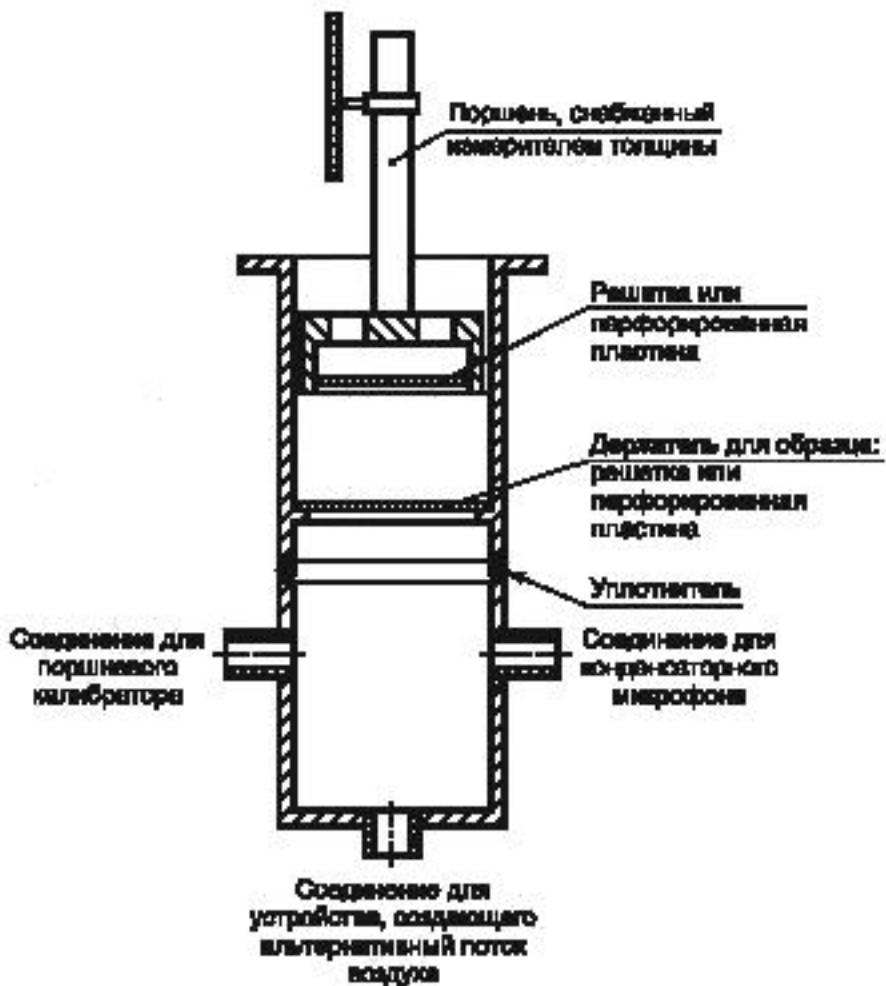
Рисунок 4 — Измерительная камера, снаженная держателем для образца, изготовленного из волокнистого, сыпучего материала или материала плотной структуры (метод В)
